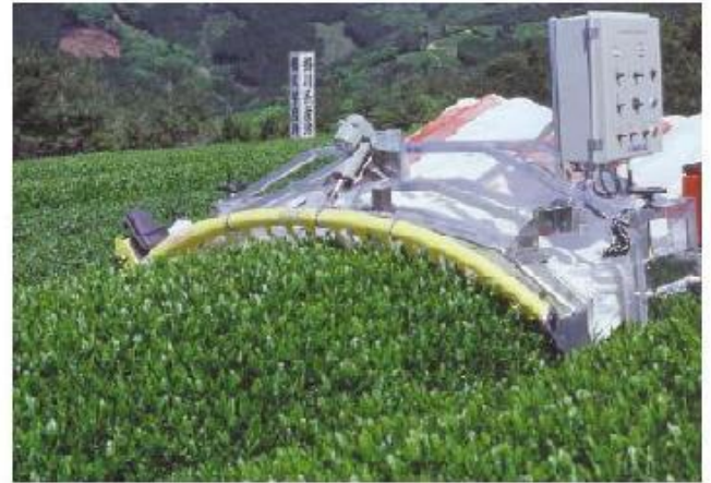
Raylı – Paletli hasat makinesi
