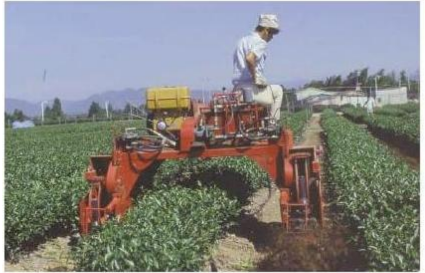
Toprağı derin işleyerek gübre uygulamak için kullanılan sürücülü tip gübre pulluğı
