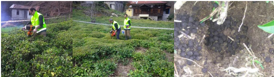
Şekil 6.1. Çay bahçelerinde bitki taç izdüşümünde burgu ile çukur açılması
